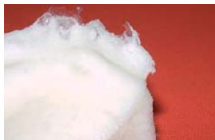
MEYCO MP 350 dopo reazione schiumosa in acqua
