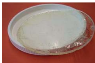
MEYCO MP 350 dopo stagionatura all'aria umida
